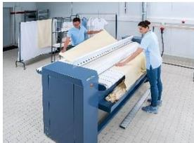
**Foto 1:** Mit mehr als 100 Kilogramm glatter Wäsche pro Stunde bieten die neuen Miele-Mangeln Höchstleistungen. Dafür sorgt unter anderem eine Mulde, die auf Luftfedern gelagert ist und sich bei Bedarf schnell hebt oder senkt. (Foto: Miele)
