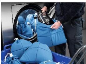
**Foto 4:** Für die Aufbereitung von Atemschutzmasken stehen eigene und ebenfalls gefütterte Schutzbeutel zur Verfügung. (Foto: Miele)
